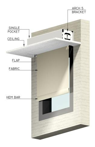
ISOMETRIC VIEW REGULAR ROLL SHADE ABOVE CEILING IN A SINGLE POCKET
