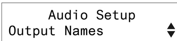
To set up an output name, press the **ENTER** button.
